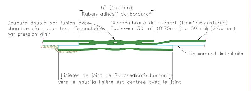
Soudure par fusion sur géomembrane Gundseal / côte géomembrane vers le haut
